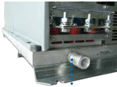
Dettaglio ingresso liquido di raffreddamento: 4...35 l/min (in funzione della taglia del drive).
