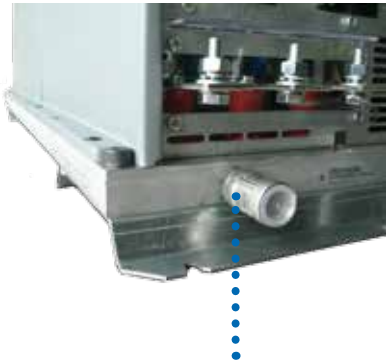
Detail Kühlflüssigkeitseingang: 4...35 l/min (je nach Antriebsbaugröße).
