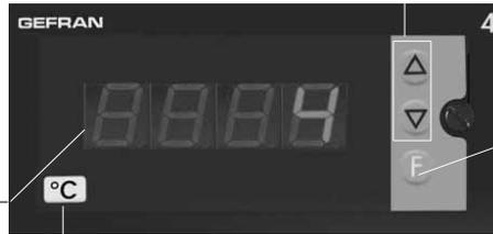
**PV-Anzeige:** Anzeige des Istwerts; Anzeige von Bereichsüberschreitungen (Hi) oder Bereichsunterschreitungen (Lo) • Anzeige von Fühlerbruch (br) oder Fühlerschluss (Er) • Anzeige von Konfigurations- und Kalibrierungsmeldungen
